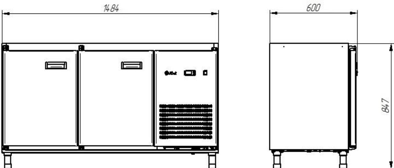
Рис.16. Габаритные размеры СХН-60-01 без столешницы (дверь, дверь)\*
