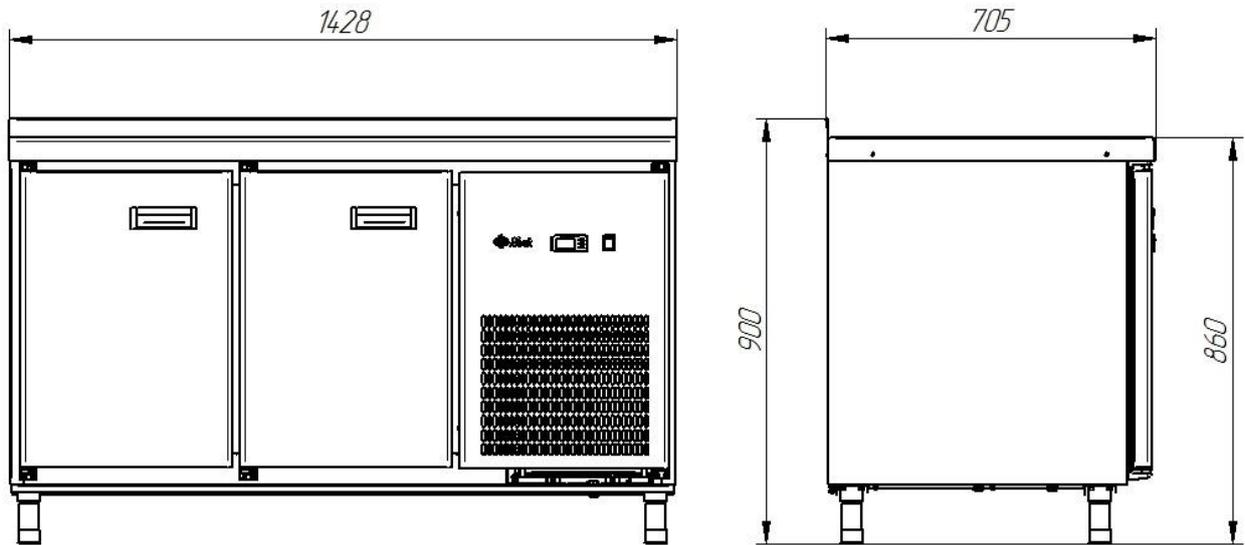
Рис.5. Габаритные размеры СХН-70-01 столешница с бортом
