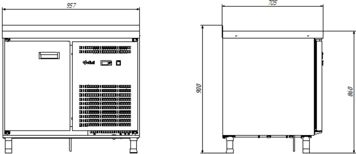
Рис.2. Габаритные размеры CXH-70 столешница с бортом (дверь)\*
