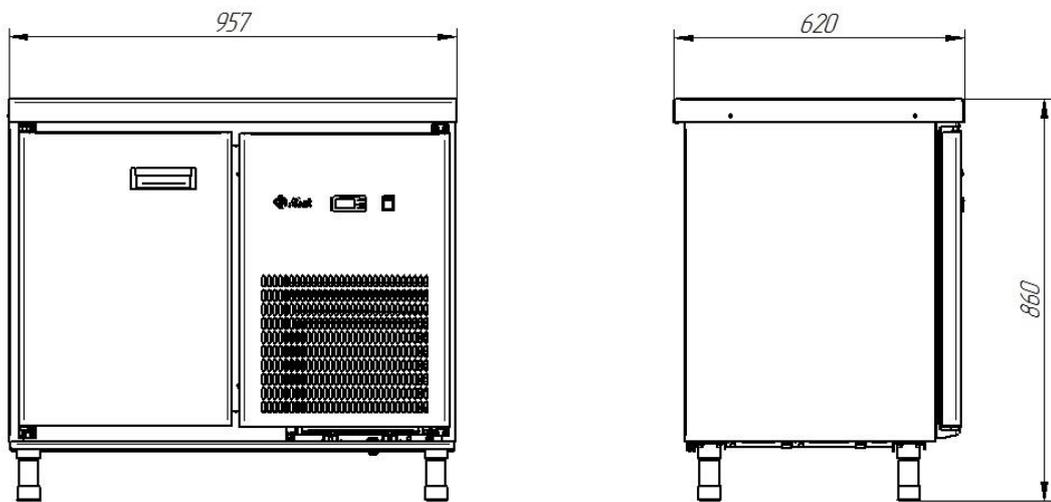
Рис.12. Габаритные размеры CXH-60 столешница без борта (дверь)\*
