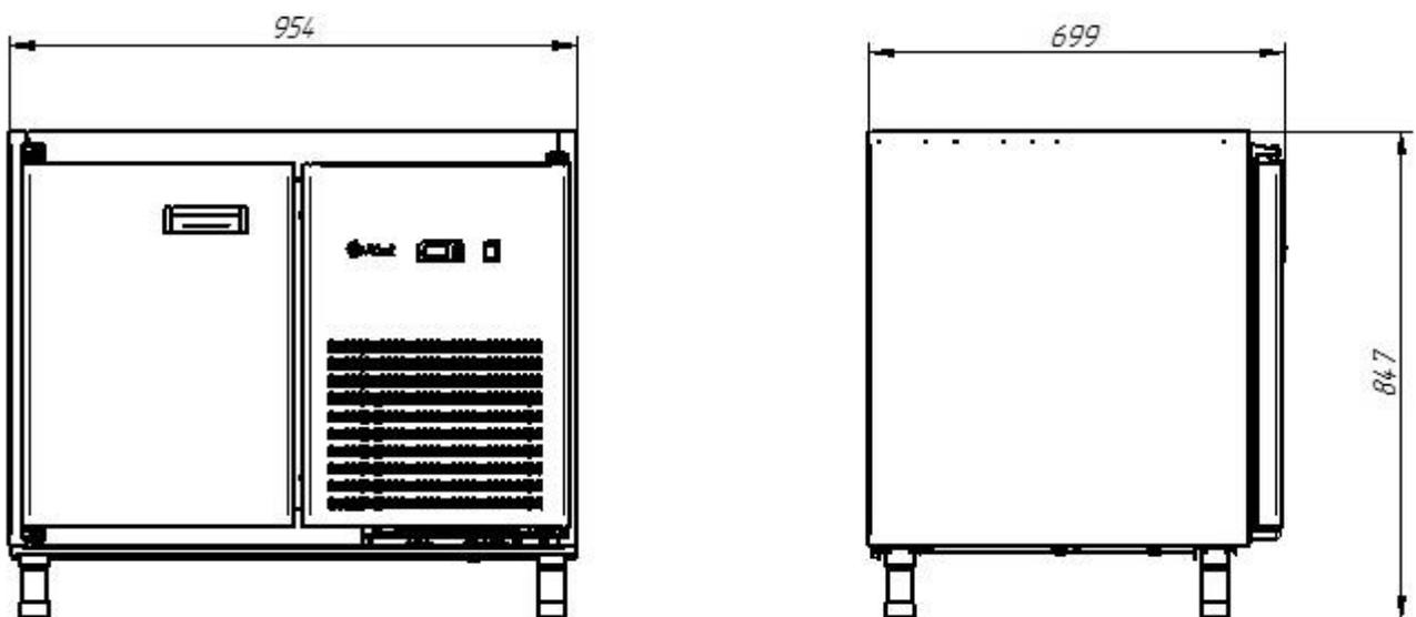
Рис.4. Габаритные размеры CXH-70 без столешницы (дверь)\*
