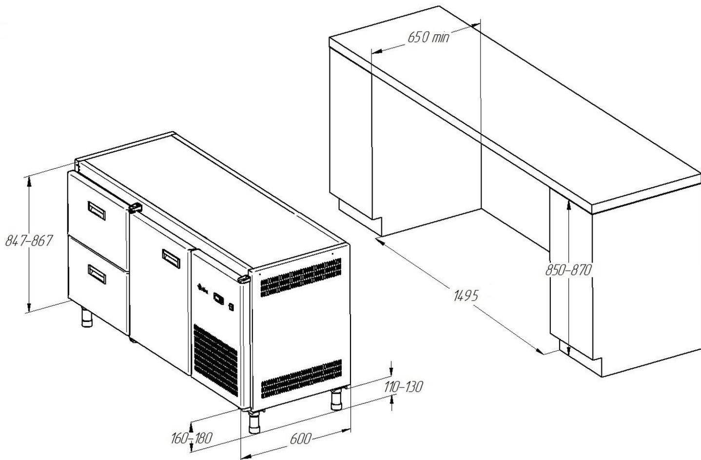
Рис.25. Схема встраивания CXH-60-01 без столешницы (дверь, ящики 1/2).
