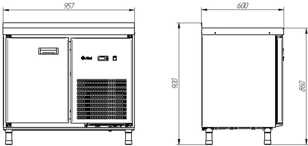
Рис.11. Габаритные размеры CXH-60 столешница с бортом (дверь)\*
