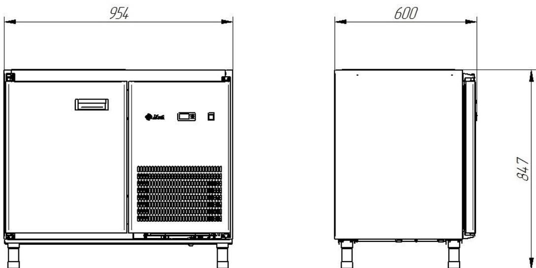
Рис.13. Габаритные размеры CXH-60 столешница без борта (дверь)\*
