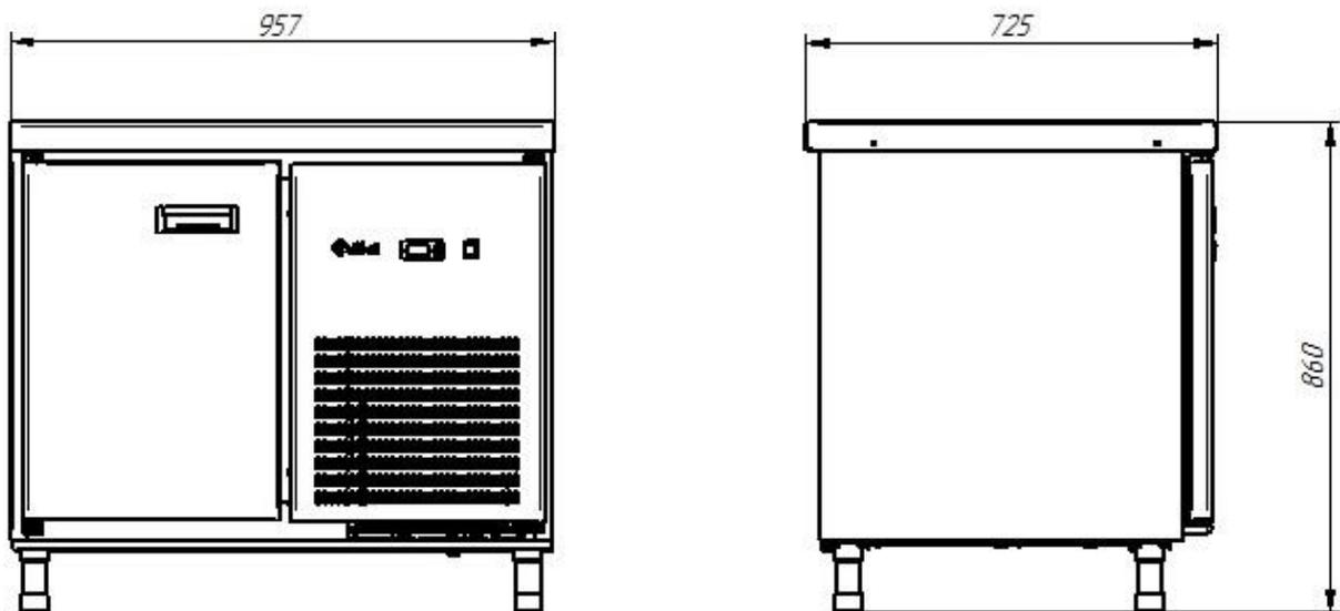
Рис.3. Габаритные размеры CXH-70 столешница без борта (дверь)\*
