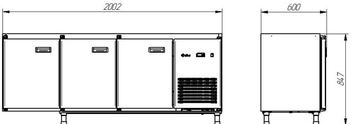
Рис.19. Габаритные размеры СХН-60-02 без столешницы (дверь, дверь, дверь)\*
