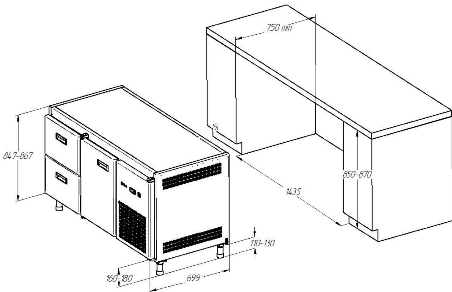
Рис.22. Схема встраивания CXH-70-01 без столешницы (дверь, ящики 1/2).
