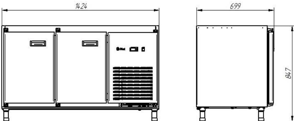
Рис.7. Габаритные размеры СХН-70-01 без столешницы (дверь, дверь)\*
