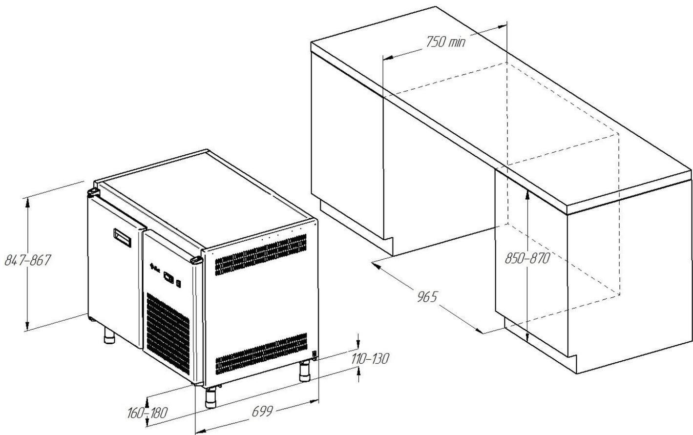
Рис.21. Схема встраивания CXH-70 без столешницы (дверь).
