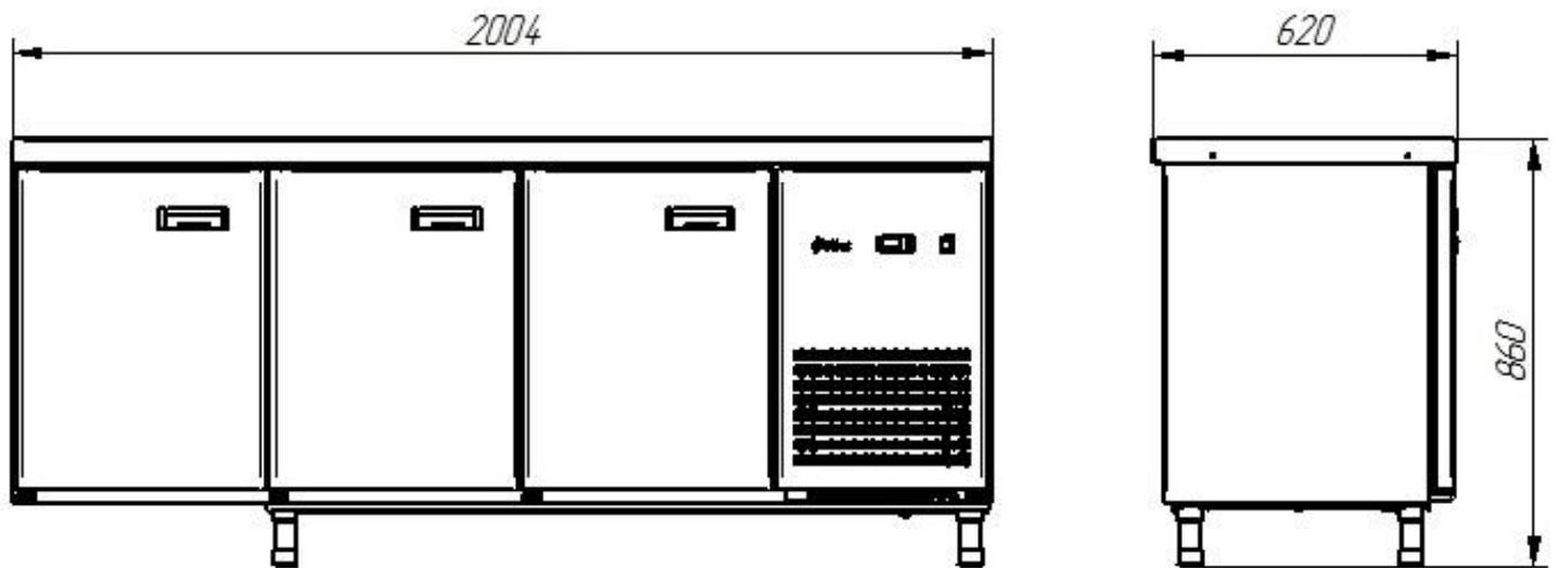
Рис.18. Габаритные размеры СХН-60-02 столешница без борта (дверь, дверь, дверь)\*
