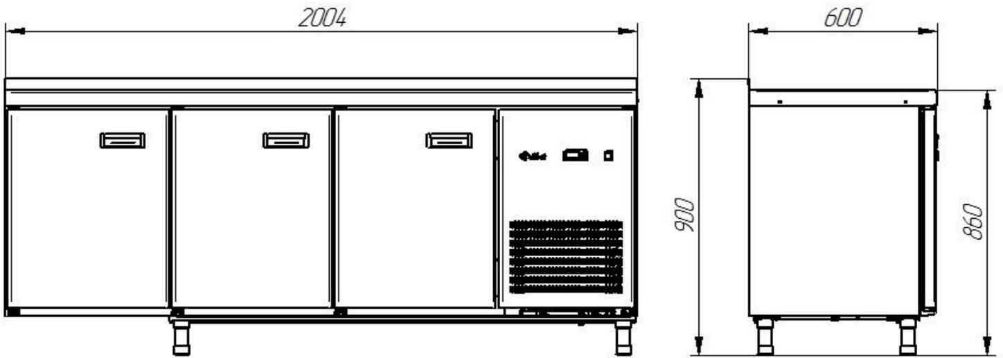
Рис.17. Габаритные размеры СХН-60-02 столешница с бортом (дверь, дверь, дверь)\*
